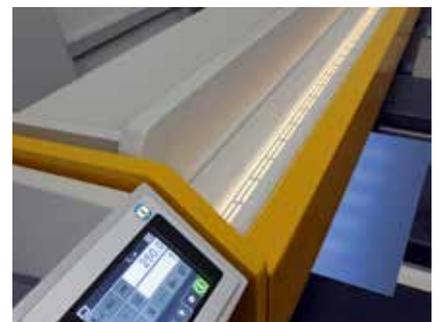
Komfortables Ausrichten der Platine nach Anriss mit LED-Schnittlinienbeleuchtung.
