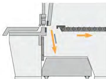
Anschnitte und Besäumstreifen fallen in den großvolumigen Schrottwagen. Er lässt sich seitlich
