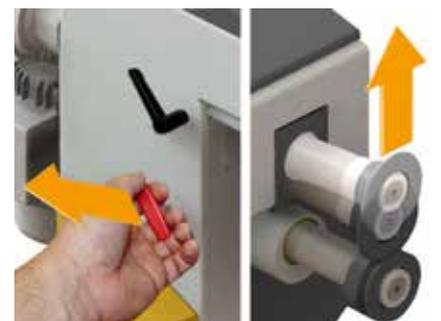
UnLock-Funktion öffnet die Wellen im Notfall.
