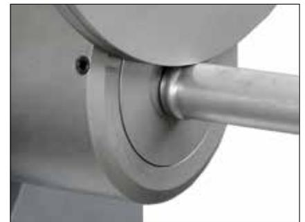
Schlauchsicke für Hydraulikrohre
