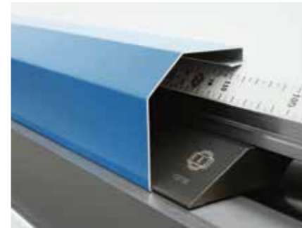
Прижимная траверса с острыми инструментами
