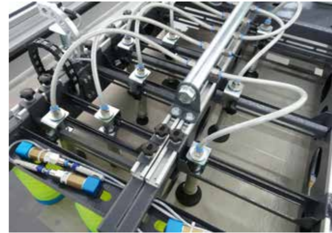
Всасывающую раму портальной загрузки с 6 предварительными и 45 свободно размещаемыми присосами.
