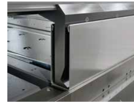
узкие, но надежные инструменты дают большую свободу гибки деталей.
