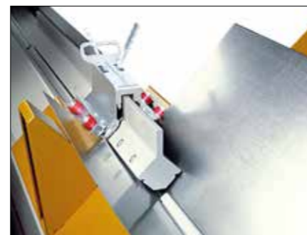
Автопилот усиленная фальцовочная балка для DuctZipper RAS 20.12.
