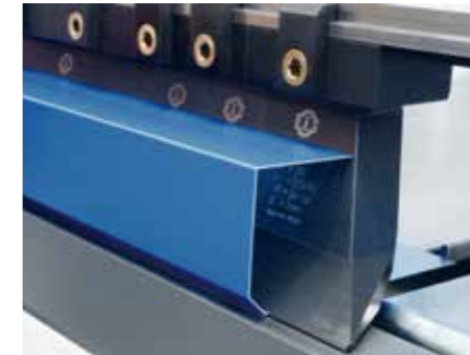
инструмент «козья ножка» со свободной зоной спереди
