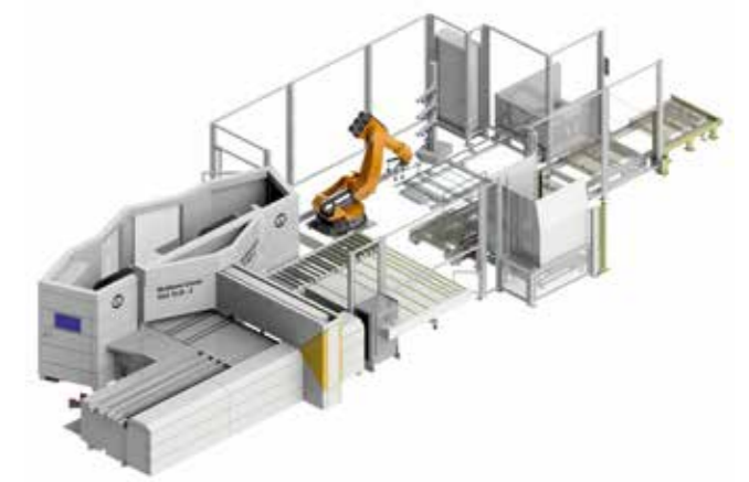
Multibend-Center с разгрузкой вручную через накопительный стол готовой продукции или автоматически при помощи интеллектуального робота. Станция переворачивания готовых деталей. Накопитель поддонов для подачи поддонов. Накопитель задних стенок поддонов, которые робот самостоятельно вставляет в поддон.
