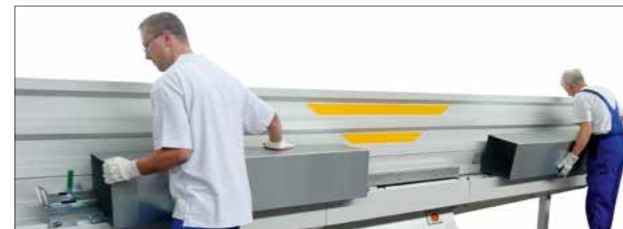
Удвоенная рабочая скорость: После извлечения первого канала оператор переключает автопилот на следующий канал, следующий воздушный канал сразу проходит через машину.
