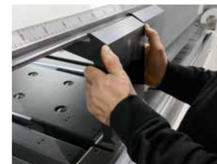
Автоматический зажим инструментов обеспечивает быструю смену.
