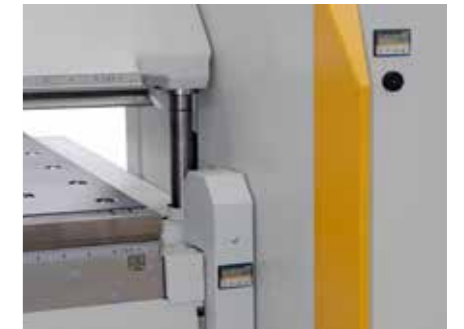
Дополнительные цифровые индикации для регулирования гибочной траверсы и стола листогибочной машины.
