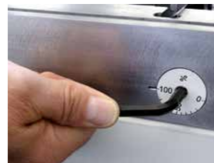
Настройка CrownTool для бомбирования инструмента гибочной траверсы.
