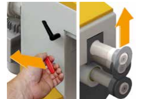
Функция UnLock раскрывает ролики в случае необходимости.
