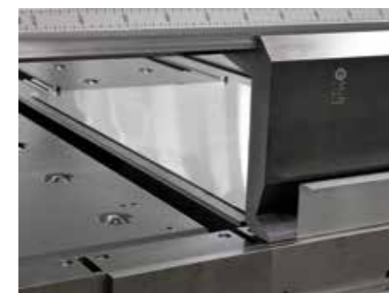
При поворотной гибке лист остается лежать на упорном столе. Приподнимать гибочные детали не нужно.
