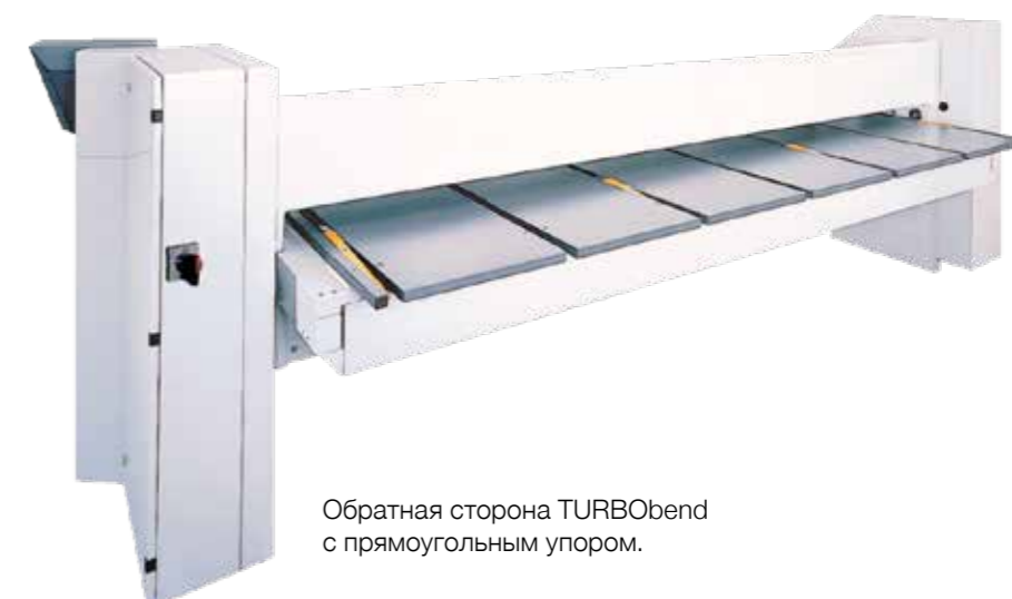
Автоматическая настройка гибочной траверсы для тонких и толстых листов.
