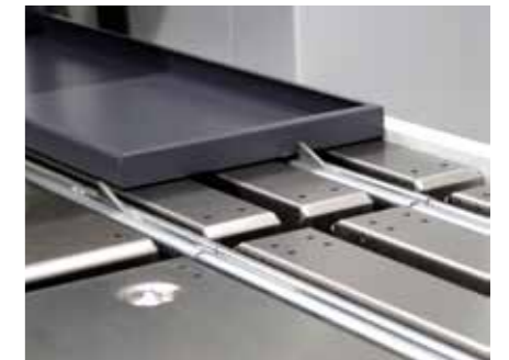
Гибочная деталь выравнивается по угловому упору.
