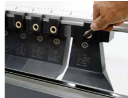
Инструменты с системой быстрого зажима
