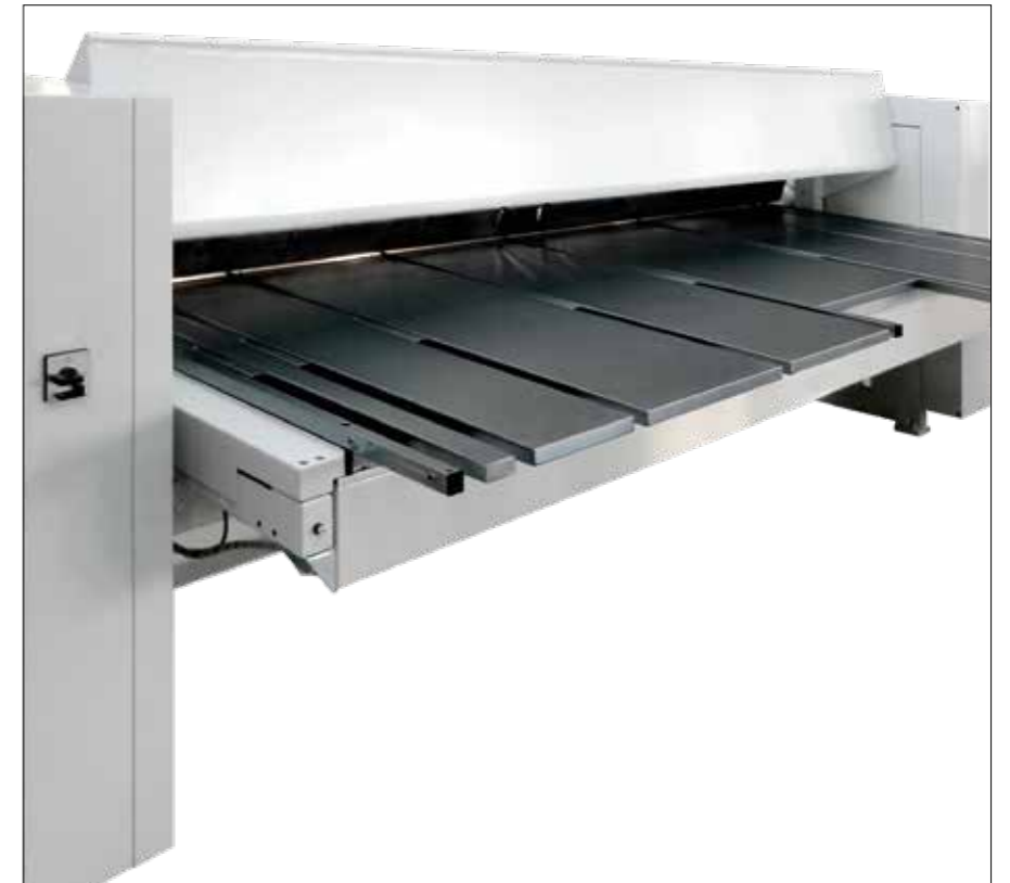
Обратная сторона TURBObend plus с прямоугольным упором
