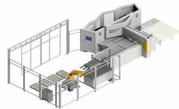
Multibend-Center с погрузкой роботом. Подача заготовок на евро-поддонах. Робот может также переворачивать заготовки. Необходимо программирование/заучивание интеллектуального робота.
