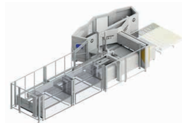
Multibend-Center z pojedynczym lub podwójnym bramowym systemem załadunkowym.
