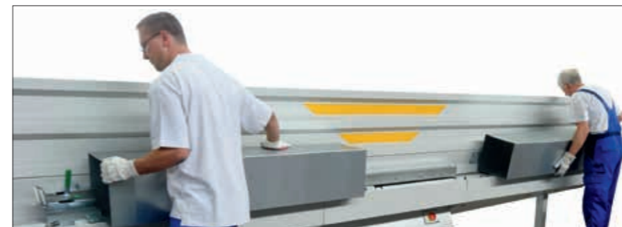
Podwojona szybkość: Po wykonaniu i zdjęciu pierwszego kanału, operator przytrzymuje następny kanał za pomocą AutoPilota i jest gotowy przekazać go na maszynę.
