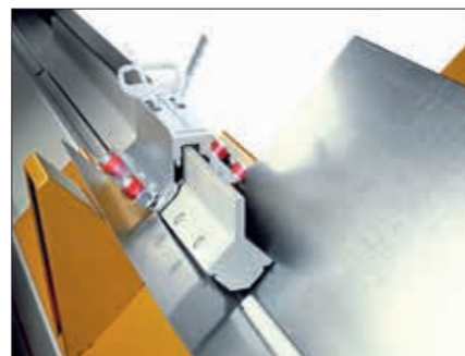
AutoPilot i wzmocniony system uchwytu blachy w RAS 20.12 DuctZipper.
