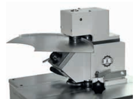
Górna przystawka do wykrawania zamka krzywkowego.
