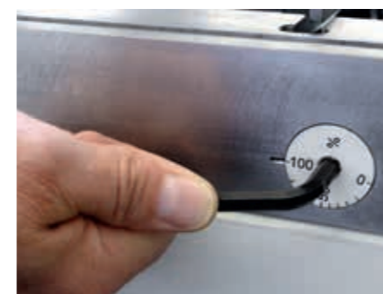
Ustawienie kompensacji strzałki ugięcia belki gnącej.
