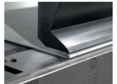
Docisk hydrauliczny oferuje imponujące możliwości podczas zamykania felców.
