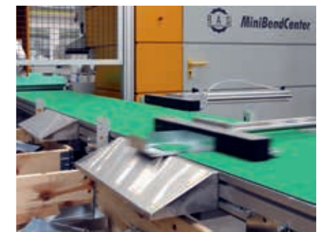
Rozładunek gotowych detali do kontenerów.
