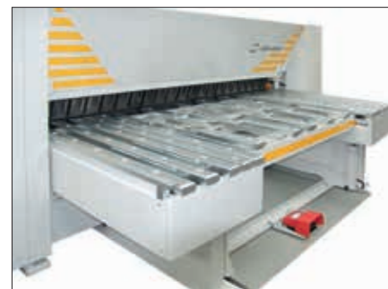
Teleskopowy system pozycjonowania w maksymalnej pozycji.
