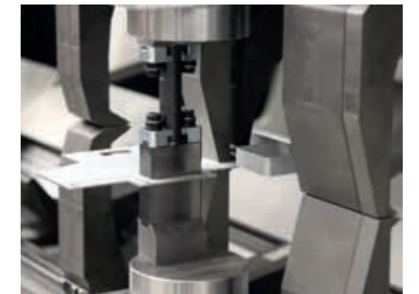
Można ustawić kilka stanowisk gięcia wzdłuż długości roboczej maszyny. Kompleksowo można wykonać detal w jednym cyklu.
