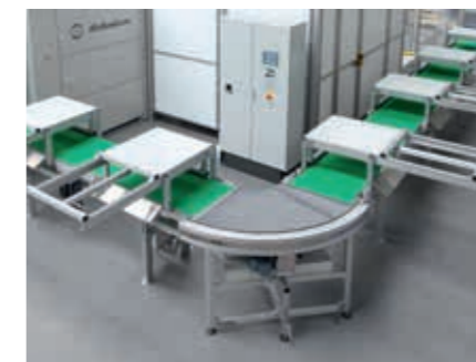
Dedykowany rozładunek gotowych detali w zależności od powierzchni hali, przepływu materiału i delikatności detali.
