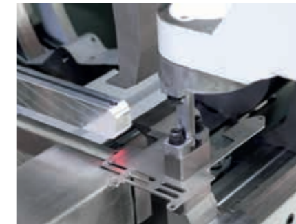
Pomiar formatek przy pomocy skanera laserowego.
