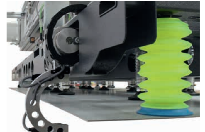
Bezdotkowy czujnik na ramie ssącej do wykrywania podwójnych arkuszy po podniesieniu.
