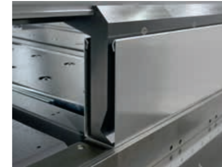
Elastyczność projektowania detali dzięki wąskim, ale wytrzymałym narzędziom.
