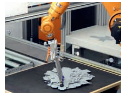
Zrobotyzowany załadunek oferuje maksymalną elastyczność. Formatki mogą być pobierane z kontenerów lub ze stosów.
