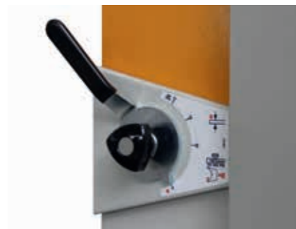
Dźwignia do regulacji szczeliny cięcia na PRIMEcut.
