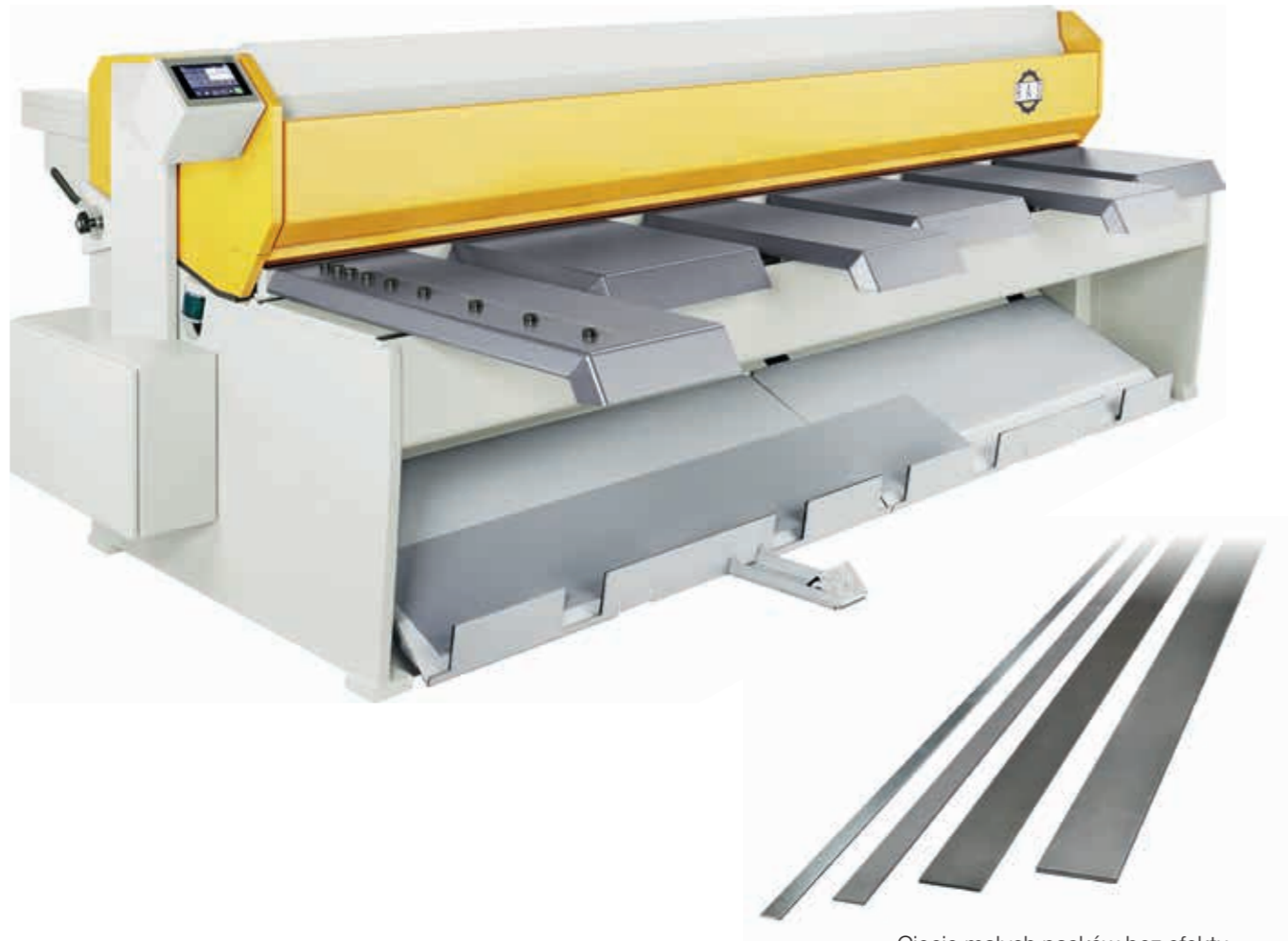
Cięcie małych pasków bez efektu skręcania.
