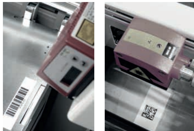
Przy module MiniFeeder lub systemie bramowym można zastosować automatyczne wczytywanie programu przez skanowanie kodu kreskowego czy QR z arkusza.
