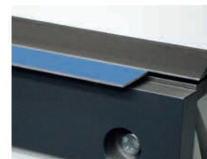
Automatyczna regulacja belki gnącej dla cienkich i grubych materiałów.
