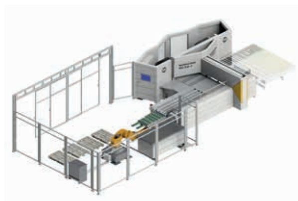
Multibend-Center z robotem załadunkowym. Pobieranie arkuszy z Europalet. Robot może obracać detale. Inteligentny robot nie wymaga programowania ani uczenia.
