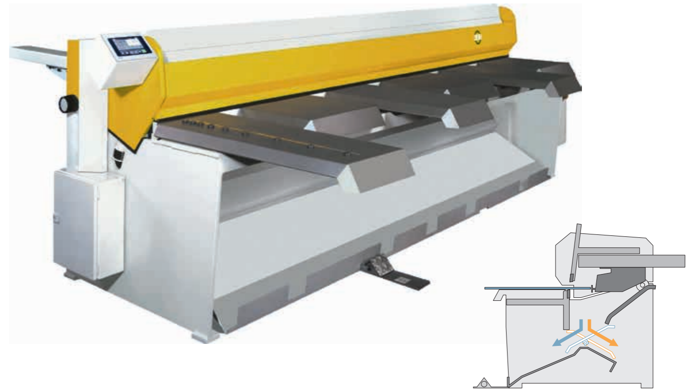
Sortowanie uciętych elementów na tył lub przód.
