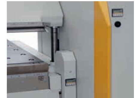
Opcjonalny cyfrowy wyświetlacz do regulacji dolnej i gnącej belki.
