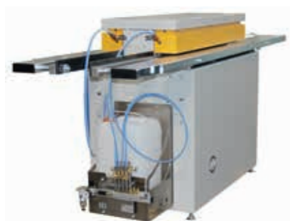
SpeedySeamer z systemem smarowania do stali nierdzewnej.
