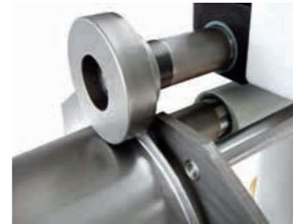
Rolki FL do zawijania kołnierzy bez obracania detalu.
