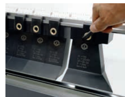
Narzędzia z szybkim systemem zaciskowym.
