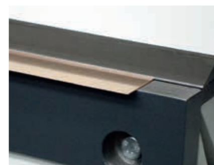
Automatyczna regulacja belki gnącej dla cienkich i grubych materiałów.
