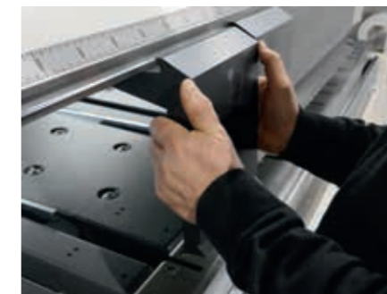
Szybkie ustawienia narzędzi dzięki automatycznemu systemowi zacisku narzędzi.
