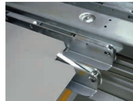
Elastyczne pozycjonowanie formatek. Pojedyncze palce zderzaka mogą być wyłączone.
