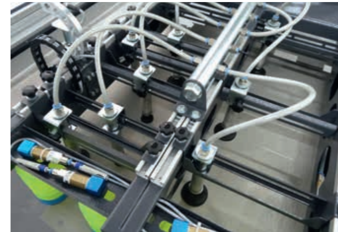
Moduł ssący systemu bramowego jest wyposażony w 6 sekcji ssących służących do podnoszenia arkusza wraz z 45 swobodnie przemieszczającymi się przyssawkami.
