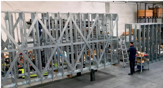
Elemente für ein Materiallager -maßhaltig gefertigt- stellen die einfache Montage von komplexen Konstruktionen, sicher.
