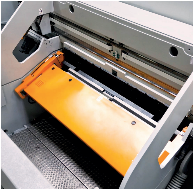
Der große Freibereich in der Biegezone ermöglicht das Biegen von großen Teilen.
