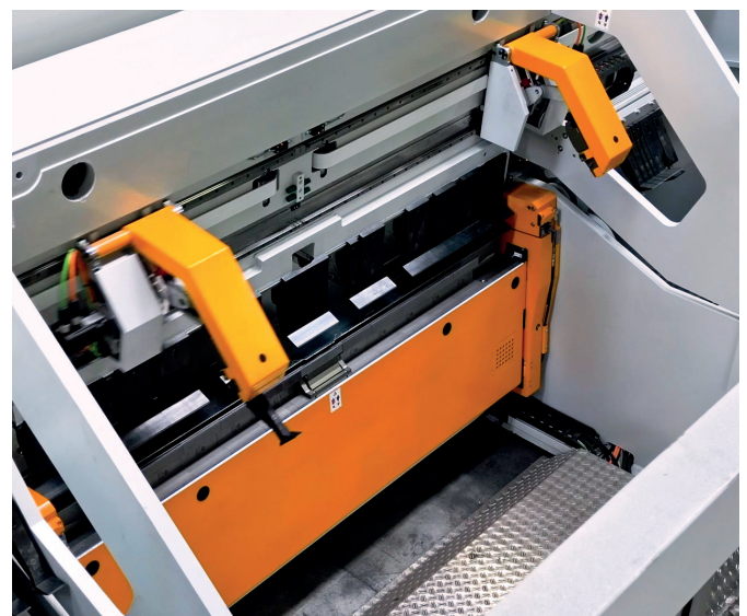
Schnelles Rüsten mit dem automatischem Werkzeugwechsler steigert die Produktionsabläufe.
