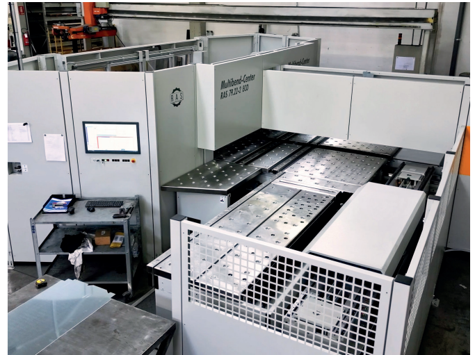
Das RAS Multibend-Center ECO zeichnet sich durch seine hohe Produktivität aus.
