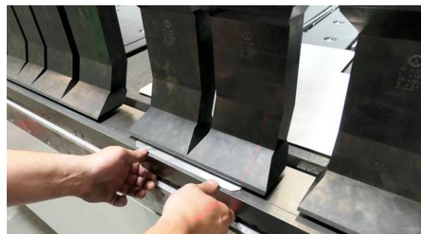
Dieser seitlich verfahrenende unscheinbare Arm auf der Oberwange zeigt dem Bediener mit einem Laserstrahl die exakte Einlegeposition der Platine oder des Biegeteils. Vorbei ist damit das Rätseln, ob man die Anschlagfinger hinter der Maschine trifft. Der ViN ist vollständig in die Software integriert und erhält seine Positionsdaten direkt aus dem programmierten Biegeteil.
