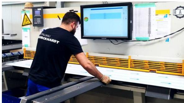
Befragt man die Mitarbeiter, was sich seitdem geändert hat, kommt einhellig zurück: "Fast alles". Neben jeder Maschine steht ein PC, der den Maschinenbedienern die eingeplanten Aufträge anzeigt. An der RAS POWERcut Schere zeigt zudem ein Großmonitor die berechnete Zuschnittoptimierung an. Die optimierte Materialnutzung spiegelt sich direkt in der Wirtschaftlichkeit der Zuschnitt-Aufträge wieder.
