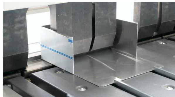
Selbst wenig erfahrene Maschinenbediener erstellen damit nach kürzester Einlernzeit hochpräzise Biegeteile. Diese Aussage kann Marcel Schiffler eindeutig bestätigen: "Als Neuling in der
