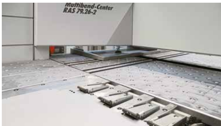
Während sich ein Teil noch im Biegebereich befindet, lädt der Roboter bereits das nächste. Das reduziert die Zeit von Teil zu Teil auf 4 s.
