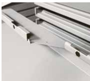
Beispiele für damit herstellbare Biegeteile. Mit einem einzigen Werkzeug biegt Honebein übrigens sein gesamtes Teilespektrum.
