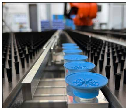
Hybridanschlag 3 in 1 mit höherer Sauggreifkraft und eigenständiger Vakuumpumpe
