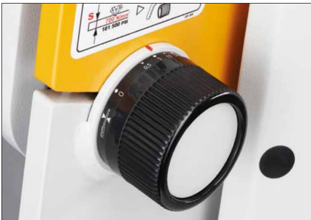
Mit einem Drehknopf lässt sich der Schnittpalt schnell und einfach auf die Blechdicke und Materialsorte einstellen.
