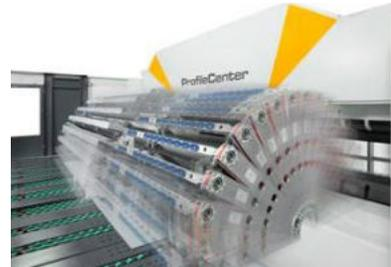
Schnelle Zykluszeiten beim automatischen Biegen, da das Werkstück im Biegeablauf nicht mehr an Anschlägen positioniert werden muss.
