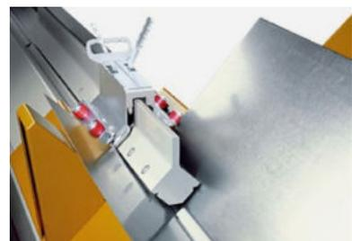
Autopilot und verstärkter Falzbalken beim DuctZipper RAS 20.12
