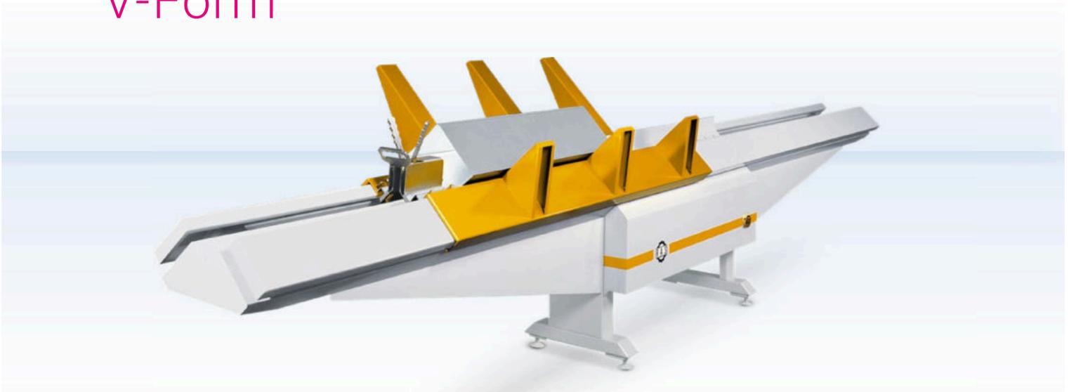
Der RAS DuctZipper-V formt und schließt die Falzverbindung an kleineren und mittelgroßen Luftkanälen. Lufttechnische Profiqualität lässt sich kaum schneller, leichter und wirtschaftlicher herzustellen. Der RAS DuctZipper schließt vorab gebogenen Luftkanal in einem einzigen simplen Durchlauf.
