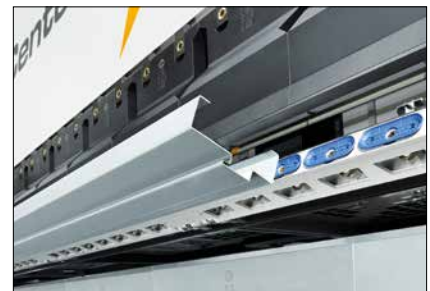
Große Freibereiche an und um die Werkzeuge ermöglichen das Biegen komplexer Geometrien
