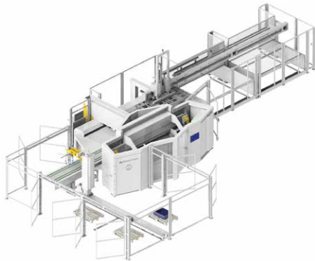
Multibend-Center mit Zwei-Platz-Portalbeladung und Stapeln über 3-Platz-Palletizer (max. 11 Stapel oder 5-Platz-Palletizer (max. 15 Stapel)).
