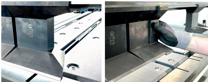
Software-geführter Werkzeugwechsel und einfache Positionierung, verkürzt Rüstzeiten und steigert Ihre Effizienz.
