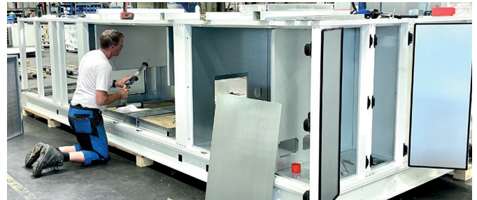
Perfekt gefertigte Komponenten ermöglichen eine passgenaue und einfache Montage der teilweise sehr komplexen Klimaanlage.
