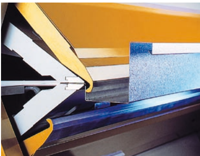
Die beiden Biegewangen biegen das Blech nach oben und unten.
