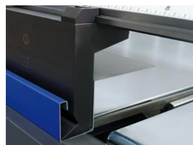
Die hinten-frei Werkzeuge für schlanke und hohe Biegeteile
