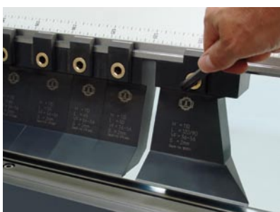
Mit dem Schnellspannsystem sind die Werkzeuge in Sekunden gewechselt
