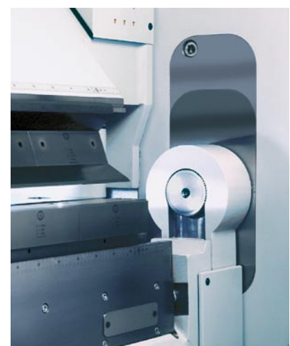
Die automatische Drehpunktverstellung sichert erstklassige Biegeteile.
