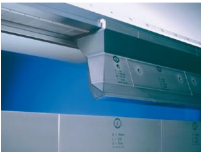
Das Klemmsystem spannt die Oberwangen-Werkzeuge automatisch.
