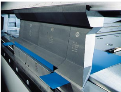
Geteilte Biegewangenwerkzeuge z. B. für versetzte Biegelinien
