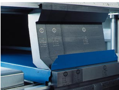
Geteilte Unterwangenwerkzeuge für gegenläufige Schenkel von bis zu 40 mm
