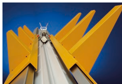
Das RAS Blech-Leitsystem mit kurzen vorderen und langen hinteren Unterstützungsarmen.
