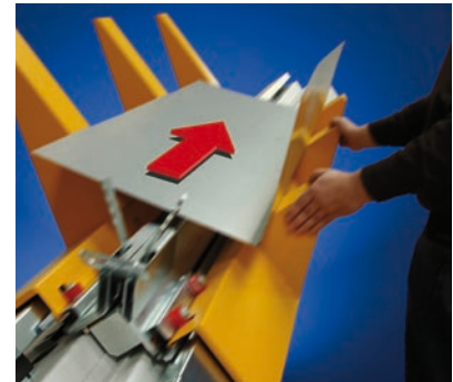
Soll ein Kanal mit mehreren Falzverbindungen geschlossen werden, schiebt der Bediener den teilfertigen Kanal mit dem Blech-Leitsystem wieder auf die Startseite zurück.
