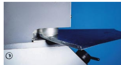
Aufsatz für Nockenstehfalz: Schneidet und prägt die Nocken für Schnappfalzverbindungen (Option)
