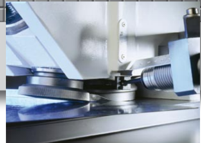
Automatische Blechführung für Bordhöhen von 8 oder 10 mm (Option)
