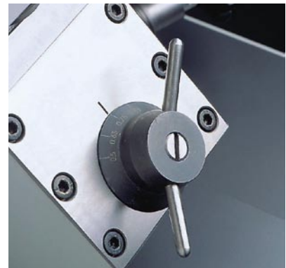
Stufenlose Blechdickeneinstellung von 0,5 –1,5 mm
