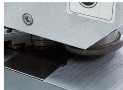
Federstahl-Einsatz und spezielle Umformrollen zum Umformen von Edelstahlblechen (Option)
