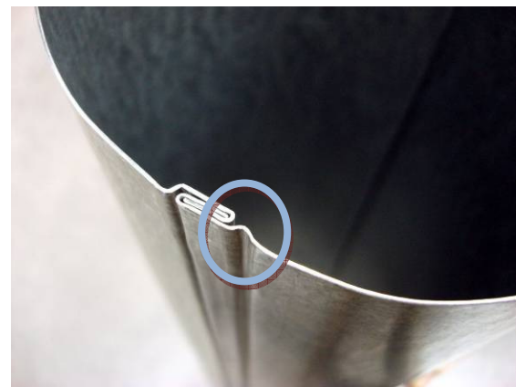
Falzverbindung mit zwei Langfalzen: Unkontrolliertes Verpressen des Materials nahe der Falzverbindung
