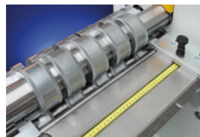
Dima per regolare velocemente la calandratura Maßband für die schnelle Voreinstellung
