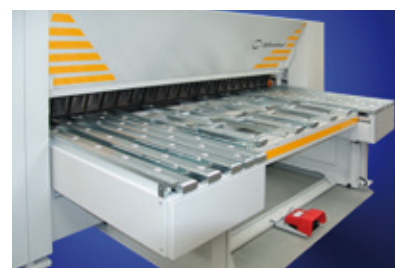
Battuta di riscontro telescopica Teleskop-Anschlagsystem
