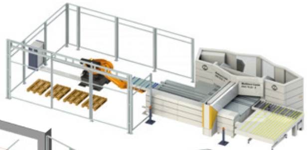
MBC con robot di carico da pallet MBC mit Roboterbeladung von Paletten
