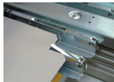
Posizionamento della lamiera tramite battuta di riscontro Positionierung der Platine durch Anschlagfinger
