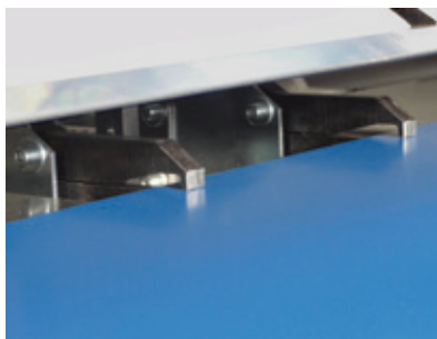
Posizionamento della lamiera tramite pinze Positionierung der Platine durch Zangen
