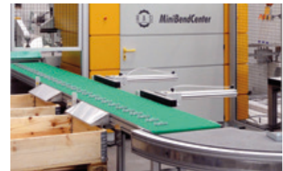
Scarico pezzi con deviatore Fertigteil-Auslauf mit Teileweiche
