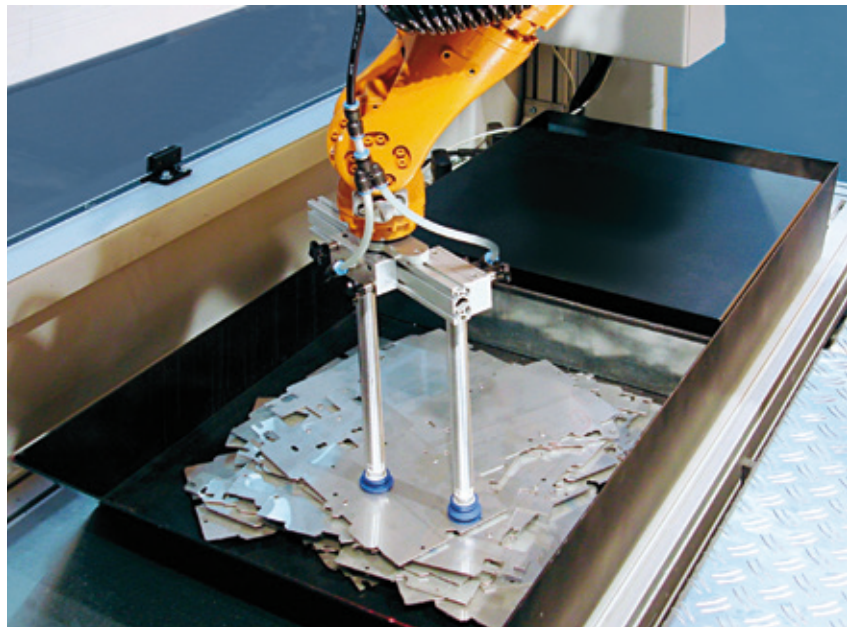
Carico robot intelligente da contenitore con lamiere sparse Intelligente Roboterbeladung aus Schüttgutkisten
