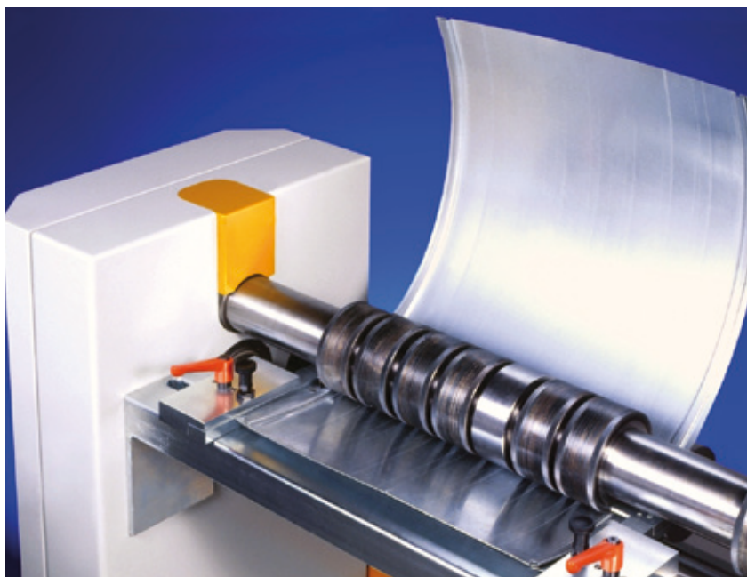
Calandratura senza segni sul lato esterno Wellenringe auf Teilbreite anpassbar
