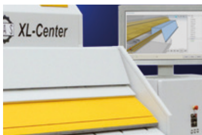
Simulazione 3D dei processi di piega 3D-Simulation des Biegeprozesses
