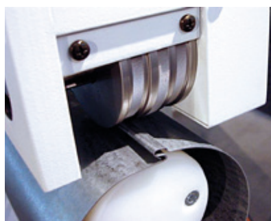
Aggraffatura esterna e interna Außen- und Innenfalz
