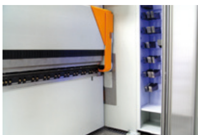
Lama di piega in posizione 180° Biegewange in 180° Position
