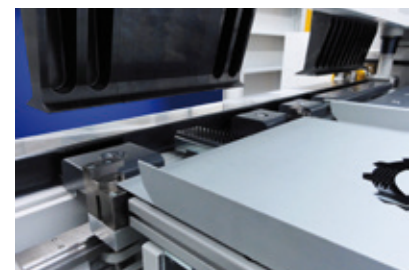
Battuta di riscontro per lamiera Anschläge zum Einlegen der Platine
