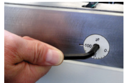
Regolazione dell'utensile CrownTool Einstellung des CrownTools
