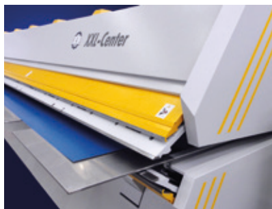
Carico semplice tramite tavolo di appoggio Einfaches Beladen durch Tischbleche
